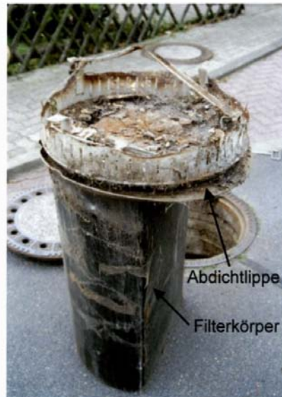
Abb. 3: Topfbiofiltermodell nach 4 Jahren im Einsatz (Asseverband) [1]
