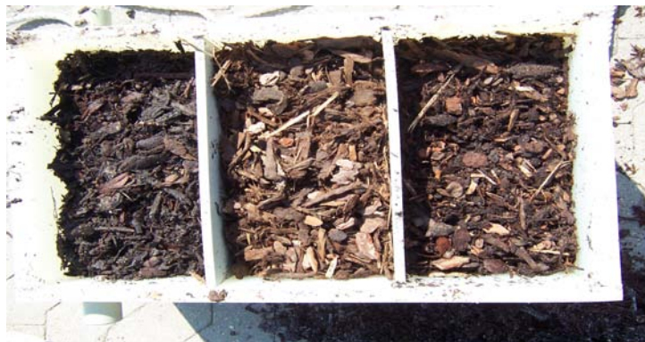
Abb. 11: Dreiteilung eines Biofilters. Bestückung v.l.n.r.: Altmulch, Frischmulch, Frischmulch + 30% Altmulch
